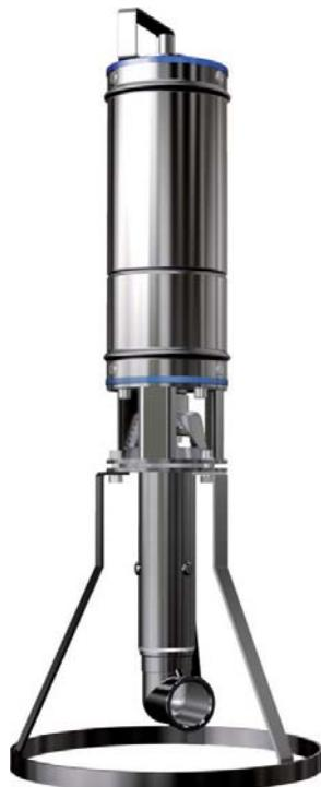
**HYDRAULICKÁ ČÁST:** Se skládá z pryžového statoru a vřetene z nerez oceli. Vřeteno je poháněno pružnou hřídelkou, která je unášena pomocí speciální spojky hřídeli elektromotoru. Tato hydraulická část umožnuje dosažení vysokého výstupního tlaku (až 1 MPa) při téměř konstantním průtoku 40 l/min při 2900 otáčkách za minutu. Materiálové provedení a konstrukce zajišťují vysokou odolnost proti opotřebení, nízkou cenu a malé zástavbové rozměry.
